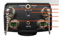
Puerto para cargador CD Medidor de potencia óptico Puerto USB
